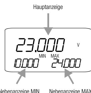
Während die Hauptanzeige unmittelbar nach dem Einschalten des Multimeters erscheint, müssen die beiden Nebenanzeigen durch Betätigen der Taste DATA/CLEAR aktiviert werden. (ausgenommen Stellung  $\text{M}\Omega@...V$ , wo die Nebenanzeigen unmittelbar nach der Anwahl der Funktion erscheinen)
